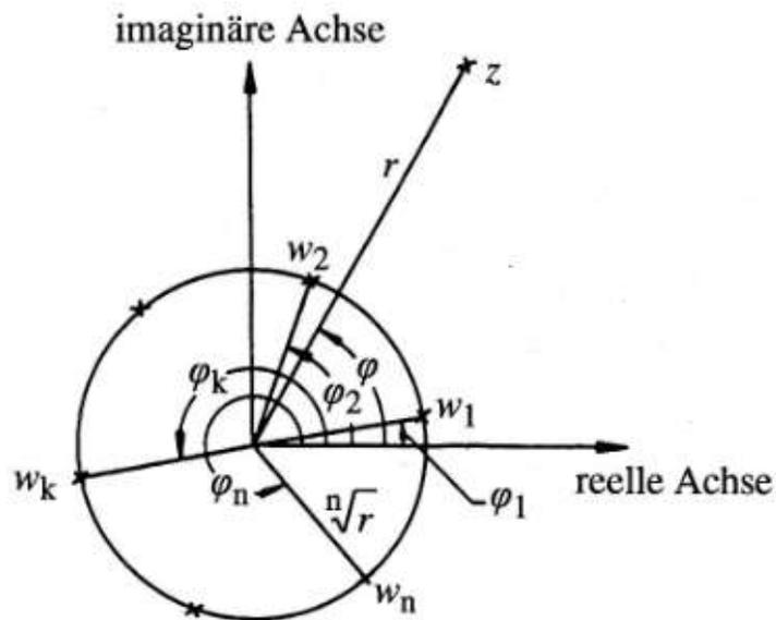
**Abbildung 1.5** Die  $n$ -ten Wurzeln  $w_1, w_2, \dots, w_k, \dots, w_n$  einer komplexen Zahl  $z$
